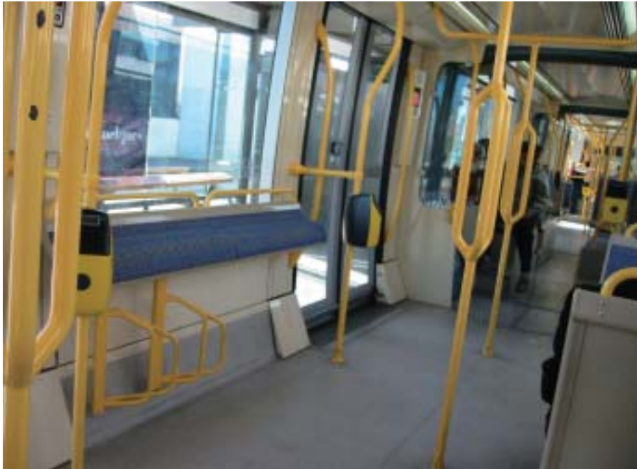
自転車と一緒に電車に乗ろう！： フランス・オルレアン市の路面電車内部。左下、改札機の右に 自転車を固定する金具が2セットある。「海外最新事情」参照。
