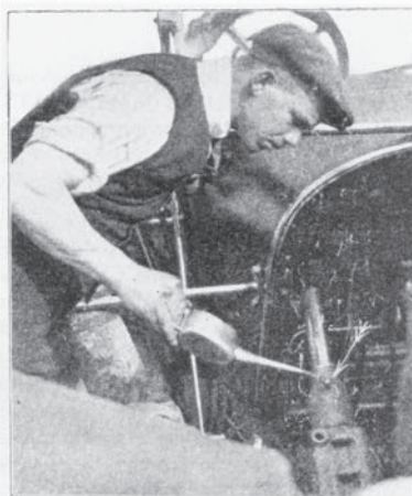
Fig. 168. Schmierung der Lenkung mittelst Oel.
